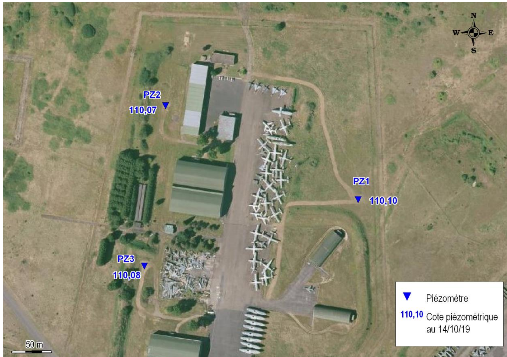
Figure 4 – Zone Nivouville : Localisation des piézomètres avec cote piézométrique d'octobre 2019 (Fond photographique Géoportail – IGN)
